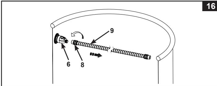
3. Svitare la valvola di rilascio della pressione (6) dal connettore filettato del filtro. Rimuovere il micro-filtro (5) dalla valvola di rilascio della pressione. Usare un tubo per innaffiare per pulire e rimuovere eventuali detriti dal micro-filtro e dalla valvola di rilascio della pressione. Vedi fig. 17.
