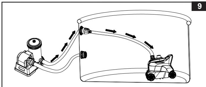
10. Avviare la pompa filtro e assicurarsi che l'acqua scorra attraverso il micro-filtro (5) e la valvola di rilascio della pressione (6). Il pulitore automatico si muoverà per pulire il fondo e le pareti della piscina. Vedi fig. 10.
